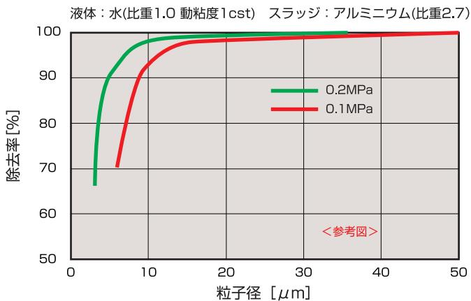
表.1 供給圧力0.2MPaでの各粒子径の除去率
