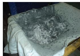
加工機：平面研削盤 材質：FC
