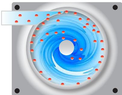
その後、スラッジはVDFのアンダーフローへと進みさらに旋回を増しながらダーティ液として排出されます。
