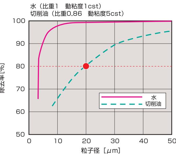
図2, 3は供給圧力0.2、0.3MPaのときの水(比重1 動粘度1cst)と切削油(比重0.86 動粘度5cst)の除去率比較を表したものです。VDFは切削油など粘度のある液体で使用した場合は、除去率は水に比べると低下しますが、5cstの切削油の場合、粒子径20μmでは80%以上除去することが可能です。
