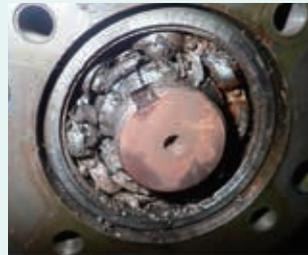
ベアリング 潤滑不良による破損
