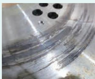
制御板(裏面) インペラー接触傷、変色
