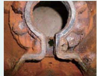
ポンプカバー内部 老朽化による穴開き腐食
