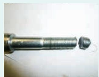
締切運動によるセンターボルト折損
