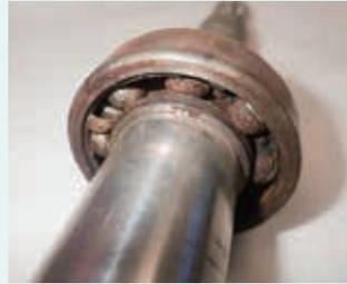
ベアリング 損傷状態
