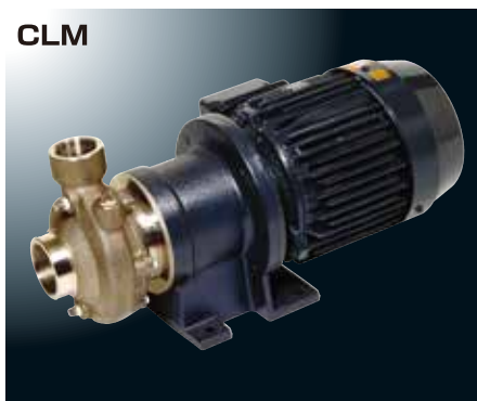
シーラレスうず巻ポンプ 低温から高温まで1台でカバーできる 装置用マグネット駆動ポンプ。
